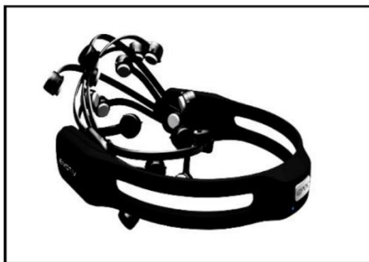
ภาพที่ 22 ลักษณะของเครื่องมือวัดคลื่นไฟฟ้าสมองแบบไร้สาย EMOTIV EPOC + ที่มา: Emotiv (n.d.)
